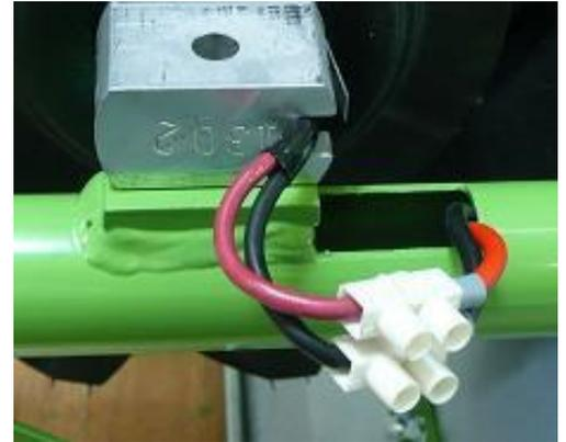
Ziehen Sie die in den Rahmen führende Verkabelung heraus, bis Sie auf den Kabelklemmenblock stoßen. Trennen Sie die Kabel, schrauben Sie die beiden M8-Schrauben vollständig heraus und entfernen Sie die Antriebseinheit.
